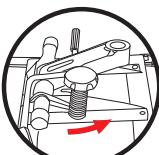
Поверните рукоятку по часовой стрелке, чтобы затянуть пружину.
