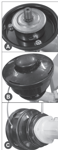
Рис. 6 Установка триммерной головки
