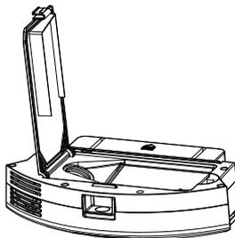
5. Извлеките два фильтра: фильтр воздушный и сетчатый. Удалите пыль с воздушного фильтра или замените на новый.
