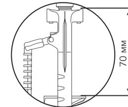
Вставить трубу перелива на 20 мм выше уровня воды. Минимальное расстояние между трубой перелива и верхней кромкой стойки - 70 мм.
