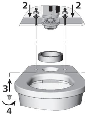
Во избежание течи из-под уплотнительного кольца крепежные гайки-барашки затягивайте равномерно с двух сторон. При подсоединении водопроводного шланга к наполнительному клапану придерживайте клапан от проворота.
