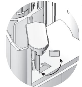
Повернуть замок поплавка малого слива и переместить поплавок перелива вверх или вниз. При перемещении вниз расход воды увеличивается.
