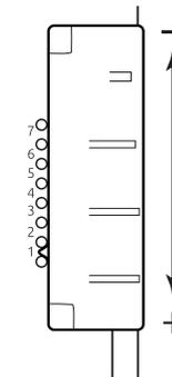
Переместить заслонку полного слива относительно корпуса сливного клапана вверх или вниз. При перемещении заслонки вниз расход воды увеличивается.
