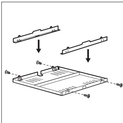
При использовании защитного экрана (приобретается отдельно) установка защитного пола непосредственно под варочной панелью не является обязательной. В ряде стран защитный экран может отсутствовать в списке доступных дополнительных принадлежностей. Обратитесь к своему поставщику.
