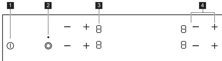
Керування приладом здійснюється за допомогою сенсорних кнопок. Символи на дисплеї, індикатори та звукові сигнали вказують на активовані функції.
