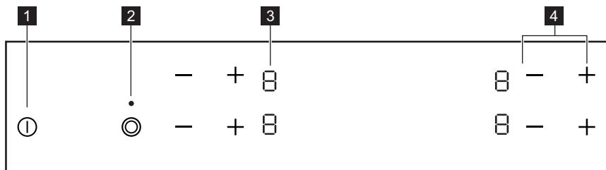
Управление прибором осуществляется с помощью сенсорных полей. Работа функций подтверждается выводом информации на дисплей, а также визуальной и звуковой индикацией.
