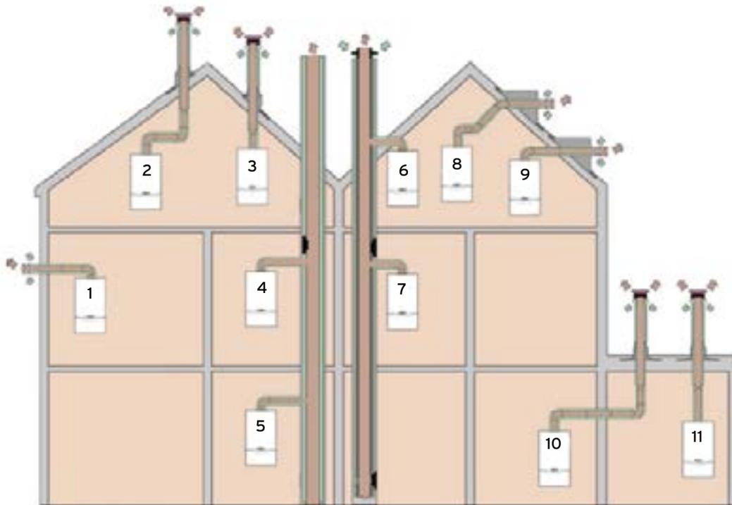
Варианты прокладки систем дымоходов / воздухопроводов  $\varnothing 80 / 80$
