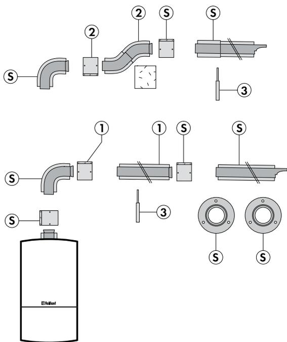
S Базовый комплект для горизонтального прохода через крышу 80/125, алюминий/сталь
