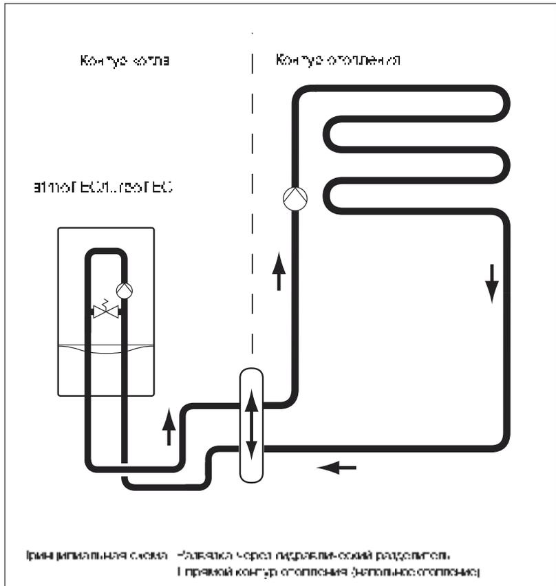
На данном примере гидравлической схемы в контуре напольного отопления используется 3-х ходовой смеситель. Смеситель подмешивает холодный теплоноситель из обратной линии в подающую линию, до тех пор, пока не будет достигнута необходимая температура теплоносителя в подающей линии.
