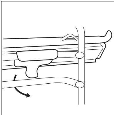
2. Стопор (A) на конце телескопической направляющей должен быть обращен вверх.
