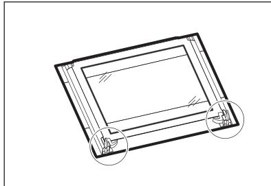
5. Вивільніть систему блокування для того, щоб витягнути внутрішню скляну панель.
