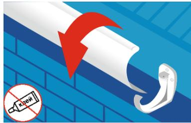
**3.2.** Уложите желоб в кронштейны. Сначала заведите в кронштейны задний край желоба. Затем надавите и защелкните в кронштейнах передний край желоба. Проверьте возможность перемещения желоба в кронштейнах.
