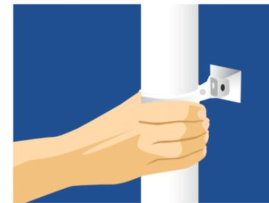
**10.2.** Нижние хомуты трубы крепятся к стене вертикально в одну линию. Максимальное расстояние между хомутами 1800 мм.
