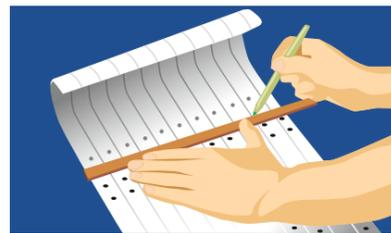
Для получения ровного одинаковогогиба кронштейнов рекомендуется использовать специальный инструмент – кронштейногиб. Согните каждый кронштейн по линии разметки на одинаковый угол в соответствии с вышеописанными правилами.
