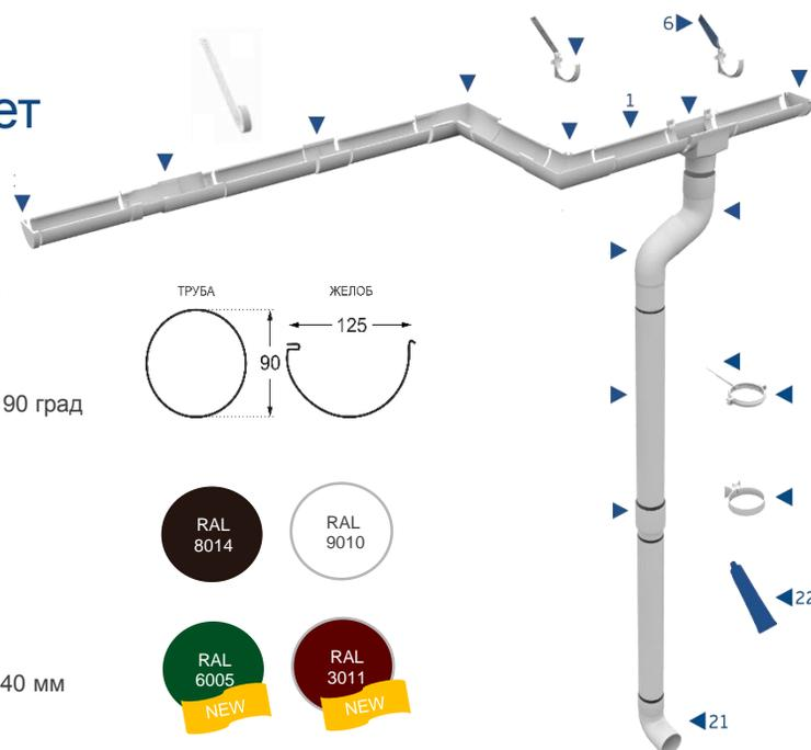
1. водосточный желоб отводной 125 мм 3 м.п.
