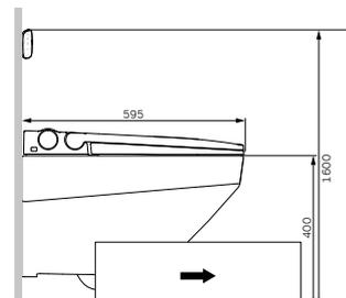
После окончания монтажа удалите подставку, двигая ее в направлении стрелки.
