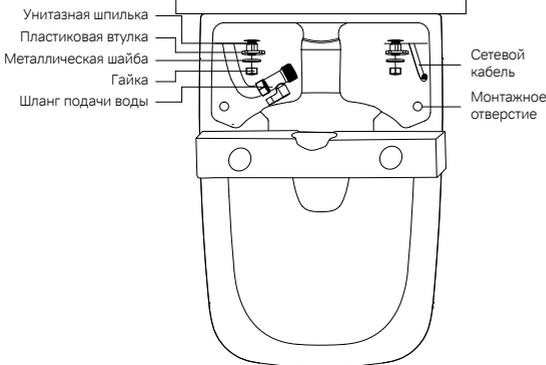
Установите продукт в горизонтальном положении с помощью уровня. Наденьте пластиковые втулки и металлические шайбы на унитазные шпильки и затяните гайки. Подсоедините шланг подачи воды к вентилю.
