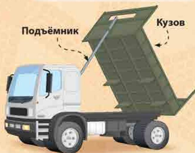
САМОСВАЛ перевозит сыпучие грузы, например песок и щебень. Кузов поднимается, и груз высыпается сам.
