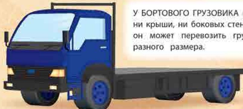
У БОРТОВОГО ГРУЗОВИКА нет ни крыши, ни боковых стенок: он может перевозить грузы разного размера.
