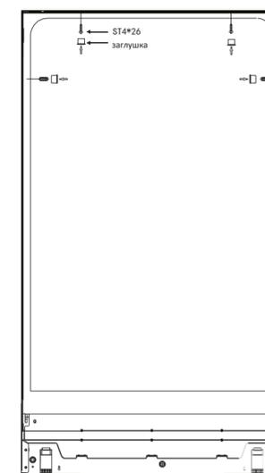
В обшивке посудомоечной машины с правой и левой стороны, а также сверху имеется 4 отверстия. Для крепления посудомоечной машины к кухонному модулю используйте деревянные винты ST4\*26 (соответствующие самонарезающие винты)
