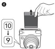
После каждого снимка число на счетчике оставшихся кадров (изначально «10») уменьшается на единицу, показывая количество оставшихся кадров. Когда на счетчике отображается «0», значит, неиспользованная фотобумага в картридже закончилась. Когда снимок будет выведен из фотокамеры (фотокамера перестанет издавать характерный звук), возьмитесь за край снимка и извлеките его полностью.
