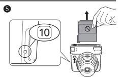
Нажмите кнопку спуска затвора. Защитный экран (черного цвета) будет извлечен из фотокамеры, а на счетчике кадров на задней панели фотокамеры появится цифра «10». Осторожно удалите защитный экран.
