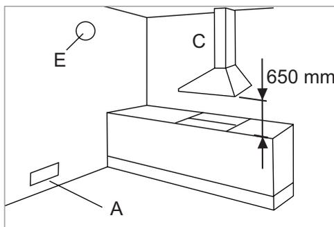
**Внимание! Минимальное расстояние между газовой варочной поверхностью и вытяжкой зависит от модели используемой вытяжки, но не должно быть менее 650 мм. Точное значение высоты установки указано в инструкции по эксплуатации вытяжки.**
