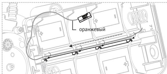
Зафиксируйте провод фиксаторами, как показано на рисунке.
