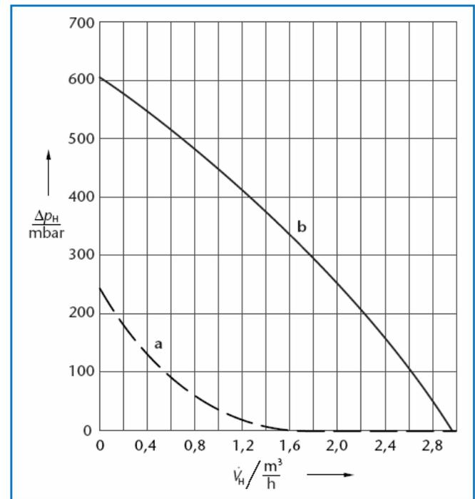
70/4 Остаточный напор системы быстрого монтажа RK 2M-E(32)/G215 (→ 37/1)
