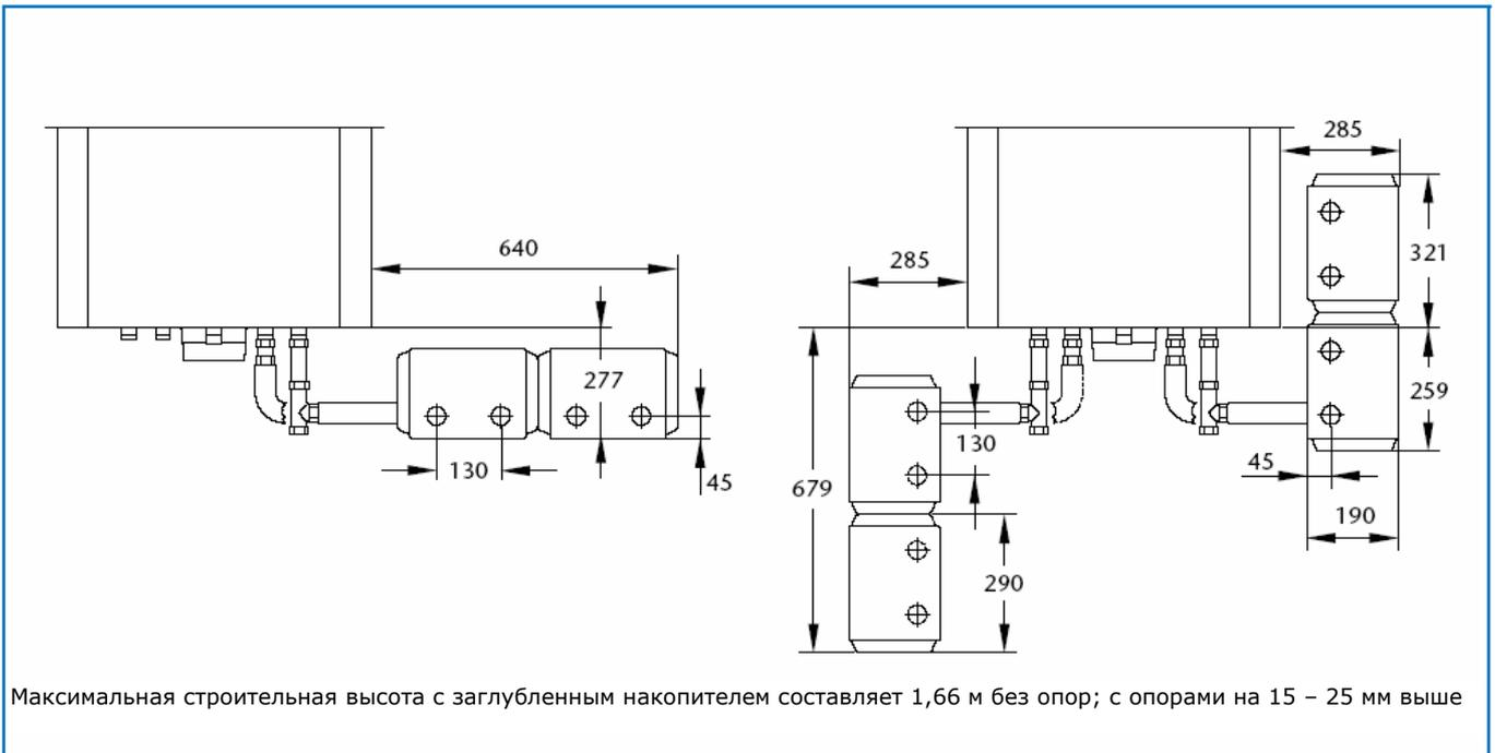
44/2 Варианты размещения системы быстрого монтажа RK 2M(-E)/S115 с газомазутным стальным отопительным котлом Logano S115 (размеры в мм)
