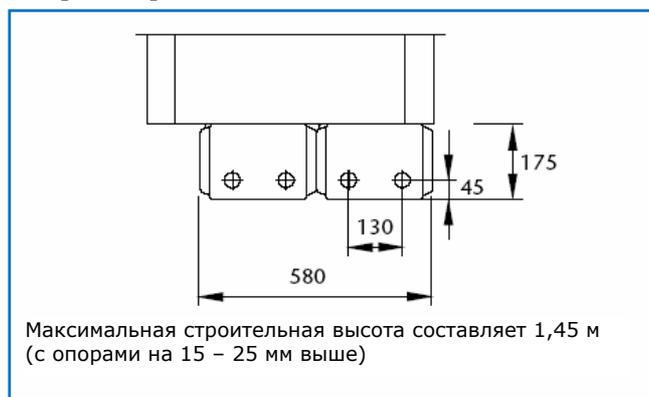
43/4 Размещение комплекта KAS 1-H/S115 в сочетании с распределительным блоком НКВ 2/25 для двух отопительных контуров позади газомазутного стального котла Logano S115 (размеры в мм)
