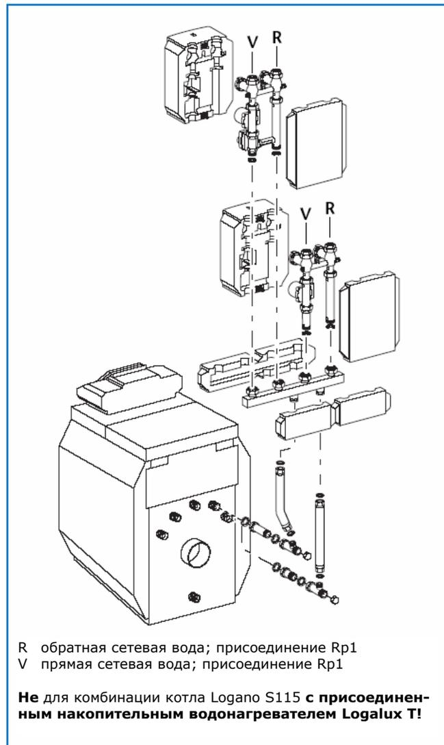
43/3 Газомазутный стальной отопительный котел Logano S115 с комплектом KAS 1-H/S115 в сочетании с распределительным блоком НКВ 2/25 для двух комплектов подключения отопительного контура
