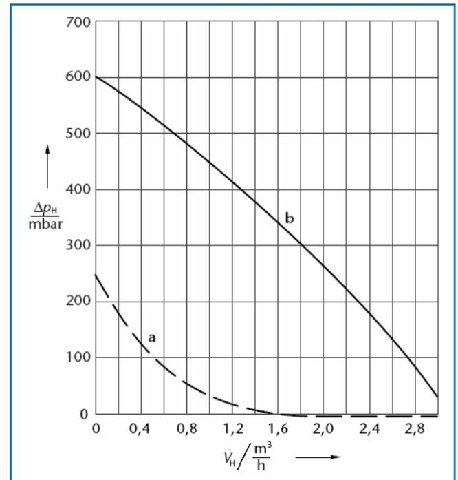
70/2 Остаточный напор системы быстрого монтажа RK 1M-E/G215 (→ 37/1)
