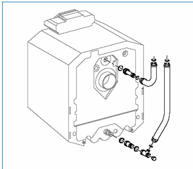
7/1 Комплект подключения котла KAS 1/G115 с газомасляным чугунным отопительным котлом Logano G115
