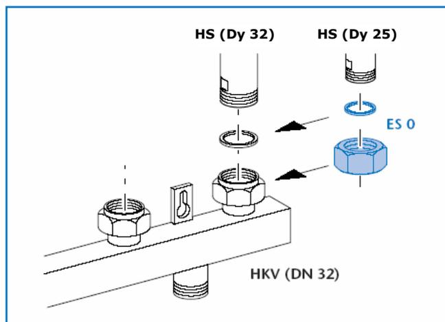
11/1 Специальная накидная гайка дополнительного комплекта ES 0 для присоединения комплекта подключения отопительного контура HSM... или HS... (Dy 25) к распределительному блоку НКВ (Dy 32)
