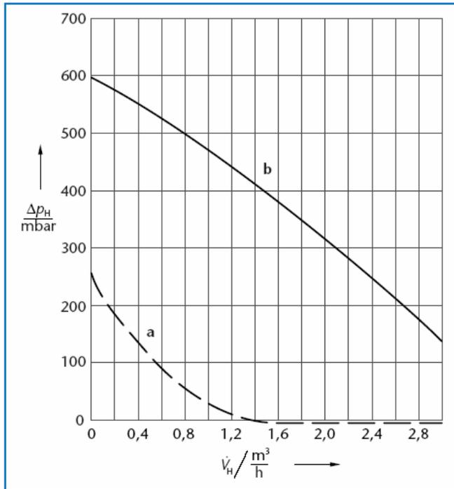
72/1 Остаточный напор системы быстрого монтажа RK 1-E(32)/W для настенной установки (→ 47/1)
