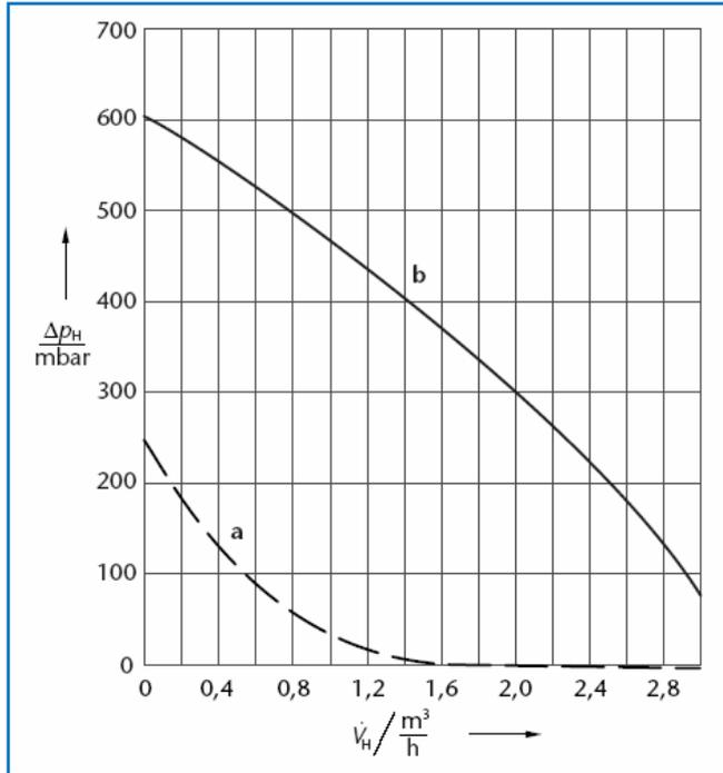
71/1 Остаточный напор системы быстрого монтажа RK 1-E/G234 (→ 27/1)
