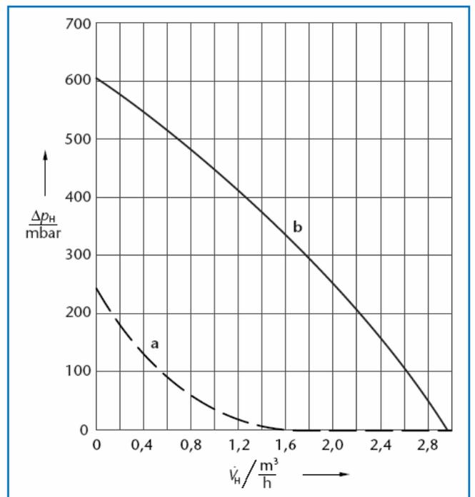
71/4 Остаточный напор системы быстрого монтажа RK 2M-E(32)/G234 (→ 27/1)
