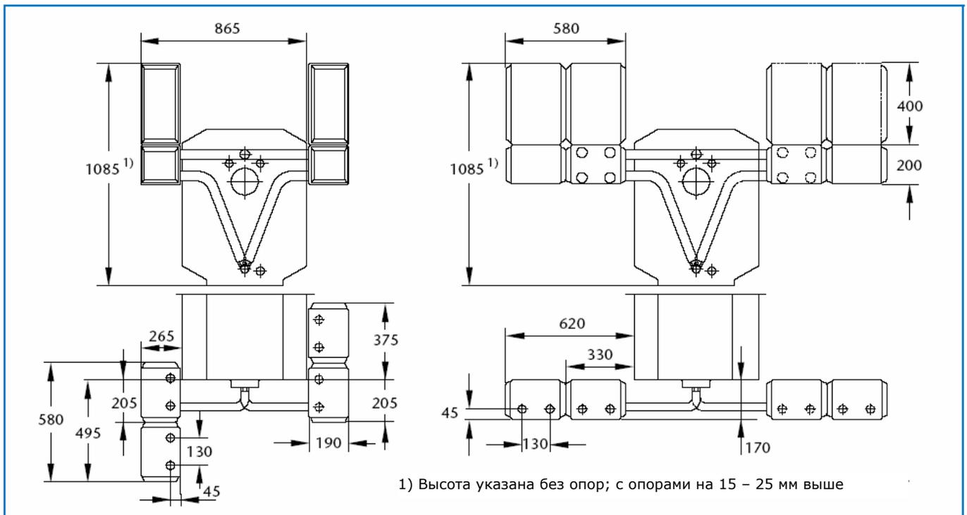
34/2 Размещение системы быстрого монтажа RK 2M(-E)/G115 с газомазутным чугунным отопительным котлом Logano G115 (размеры в мм)
