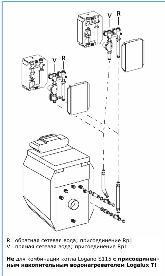
43/1 Газомазутный стальной отопительный котел Logano S115 с комплектом KAS 1-H/S115 в сочетании с одним комплектом подключения отопительного контура
