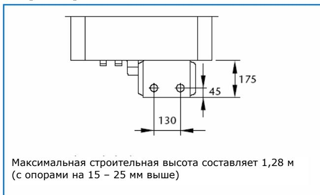
43/2 Размещение комплекта KAS 1-H/S115 в сочетании с одним комплектом подключения отопительного контура позади газомазутного стального котла Logano S115 (размеры в мм)
