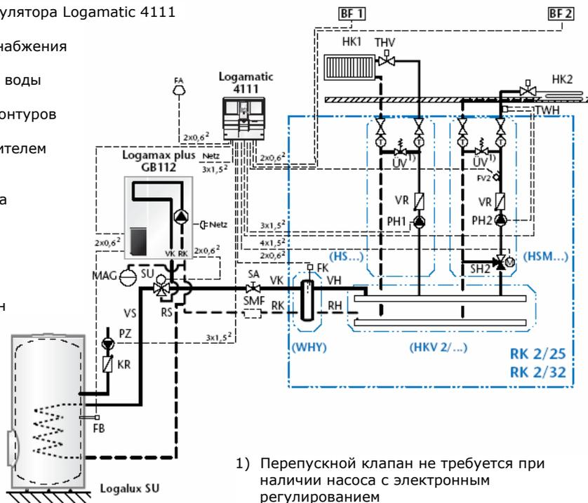
Пример гидравлической схемы, в которой потребный объемный расход установки превышает максимально возможный аппаратный объемный расход (подачу встроенного сетевого насоса). Пример показывает возможное решение схемы – без претензии на полноту. Для практического исполнения действуют соответствующие технические правила. Предохранительные устройства выполняются по местным правилам.
