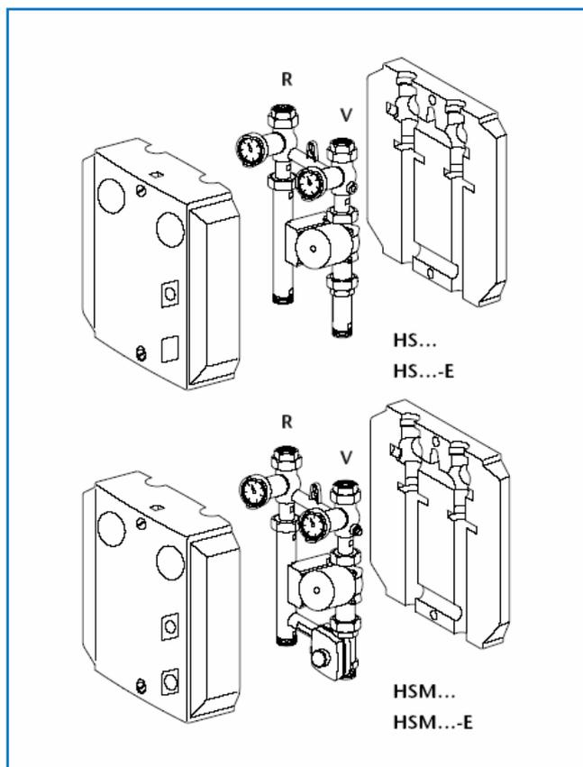
10/1 Комплект подключения отопительного контура HS...(-E) и HSM...(-E)
