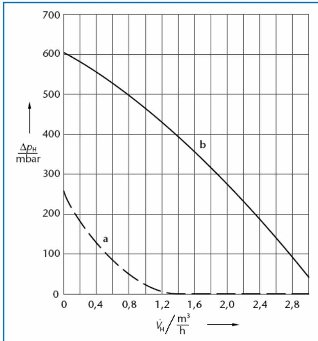
70/1 Остаточный напор системы быстрого монтажа RK 1-E/G215 (→ 37/1)
