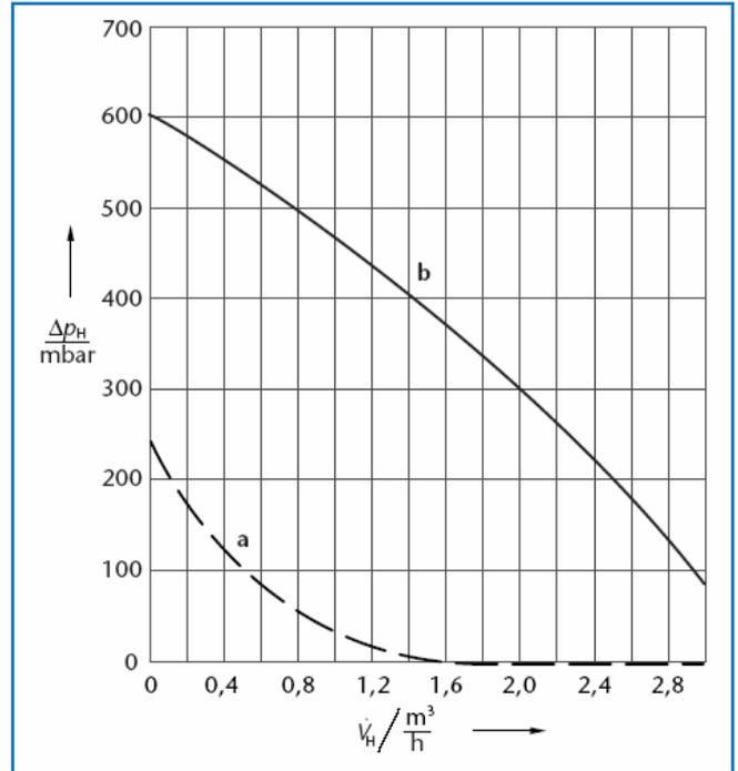
71/2 Остаточный напор системы быстрого монтажа RK 1M-E/G234 (→ 27/1)
