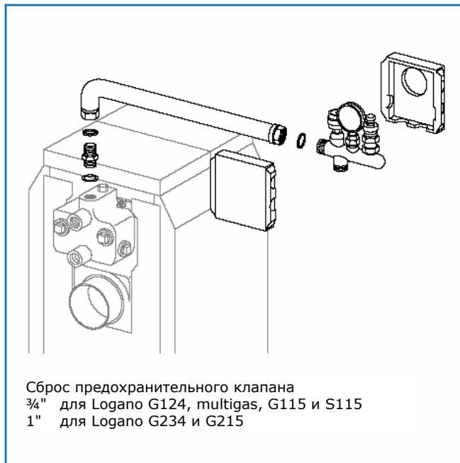
Сброс предохранительного клапана
