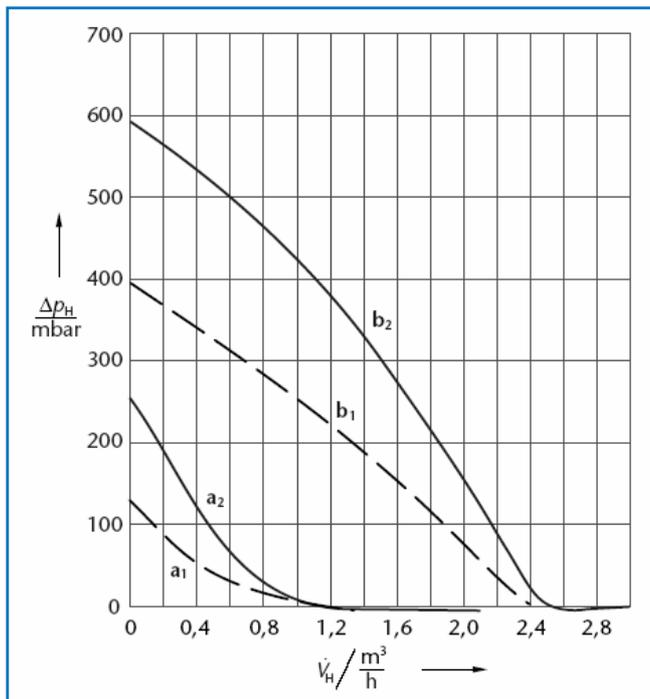
70/3 Остаточный напор систем быстрого монтажа RK 2M(25)/G215 и RK 2M-E(25)/G215 (→ 37/1)
