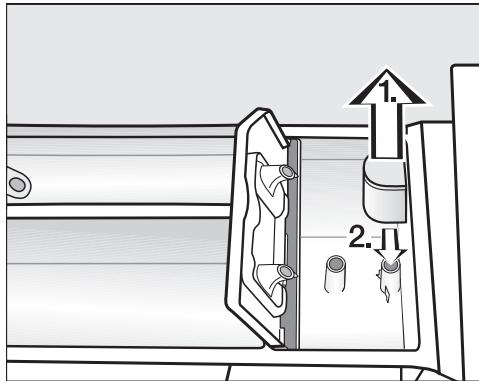
1. Вытяните сифон из ячейки ❧ и промойте под струёй тёплой воды. Также вымойте трубку, на которой находится сифон.
