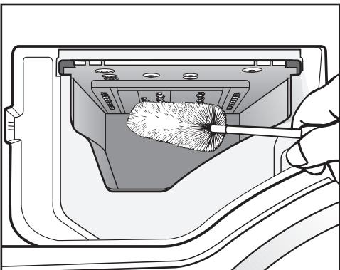
■ С помощью ёршика для мытья бутылок регулярно удаляйте остатки моющих средств и отложения извести с форсунок подачи воды в отсеке.
