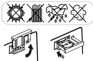
2. Подключите батарею: потяните ее за ручку вверх, а затем протолкните в устройство.
