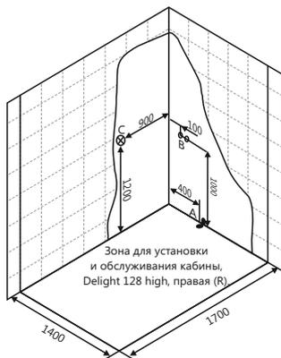
**А** – вывод канализации устраивается в уровень с полом из стены, или из пола под срез кафельной плитки. Допускается уровень канализационной трубы не выше 7см над уровнем пола в верхней точке. Если высота канализации не позволяет вывести на данную высоту вывод, то изготавливается подиум, повторяющий форму кабины (бокса, ванны) с допуском по периметру не менее 5 см. Высота подиума зависит от высоты вывода канализации. Подиум, также как и пол под ванной должен быть выложен плиткой. Рис. 1.
