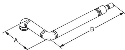
$$A + B - (\text{Колено } 1 \times 90^\circ) = 8 - 1,5 = 6,5\text{м}$$
