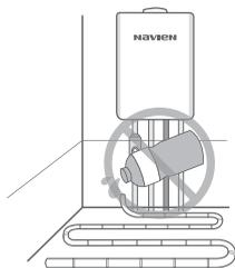
3. Котлы Navien Deluxe One оснащены встроенными сетчатыми фильтрами отопительной воды. На обратном трубопроводе системы отопления, перед котлом, рекомендуется установить дополнительный косой сетчатый фильтр, для очистки отопительной воды от нежелательных примесей.
