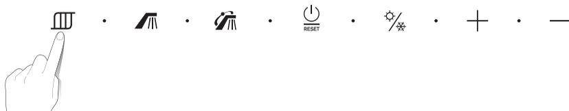
1. При нажатии кнопки нагрева (▯▯▯) в течение 2 секунд, значок повторного нагрева (☉) преобразуется в режим повторного нагрева.
