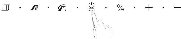
1. В отображении кода неисправности, нажмите клавишу (🔌).
