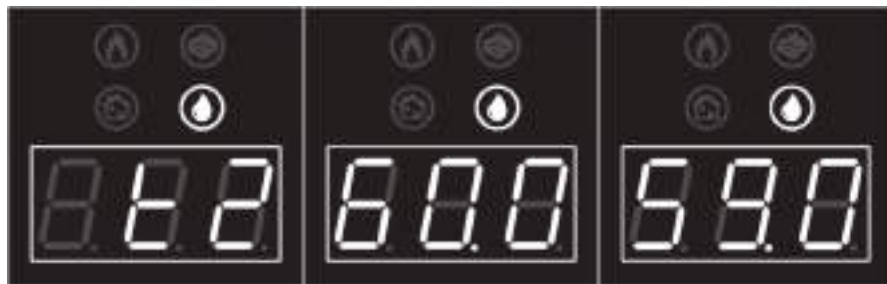
Рисунок 3 — Настройка границ температуры теплоносителя
