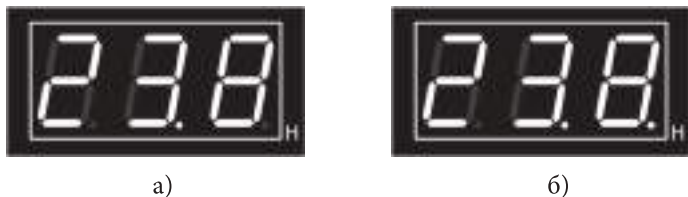
Рисунок 2. Основной режим работы и режим установки температуры: а – нагрев выключен, б – нагрев включен.
