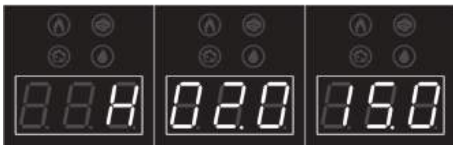
а) б) в) Рисунок 8 — Установка паузы включения и выключения насоса
