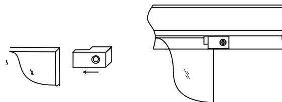
Зафиксируйте стекло при помощи L-образного фиксатора 05, закрепите винтом.
