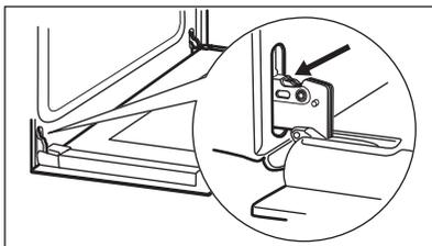
**Пункт 3** Прикройте дверцу наполовину до первого фиксируемого положения. Затем вытяните дверцу вверх и вперед из ее гнезда.
