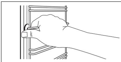
**Пункт 3** Вытяните заднюю часть направляющей из боковой стенки и снимите ее.
