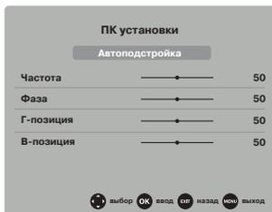
Настройте телевизор, чтобы использовать его как монитор при подключении к компьютеру по VGA-кабелю. Убедитесь, что ПК и ТВ выключены. Подсоедините VGA кабель в выход видеокарты компьютера и ко входу на ТВ. Включите устройства. Используя клавишу SOURCE на ПДУ выберите источник входа VGA.
