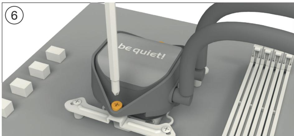
Разместите блок охлаждения процессора по центру над монтажными кронштейнами Intel (4) и закрепите его. Для этого вы можете использовать обычную крестовую отвертку. Затем подключите помпу и светодиодную подсветку к SATA-переходнику (18).
