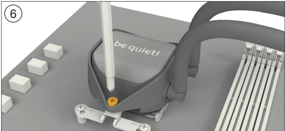
Разместите блок охлаждения процессора по центру над монтажными кронштейнами AMD (5) и закрепите его. Для этого вы можете использовать обычную крестовую отвертку. Затем подключите помпу и светодиодную подсветку к SATA-переходнику (18).
