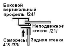
Установите собранный каркас душевой кабины на поддон /15/. Выровняйте на поддоне каркас душевой кабины по переднему бортику.
