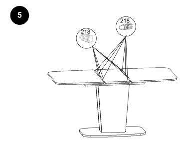
Металлический шкант 218 вставлять в отверстия в торце столешниц, шканты устанавливаются комплектами(шкант со штырём в столешницу 1, ответная часть в столешницу 1, в ставки стола утановить ответные части, напротив.
