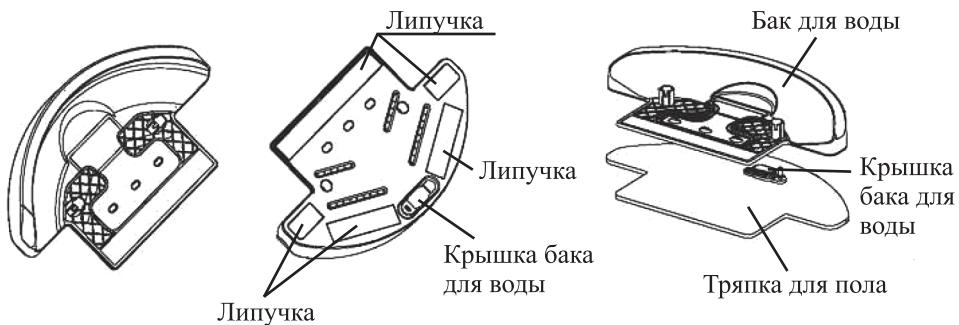
Моющий модуль крепится на дне пылесоса с помощью выступов-защелок, входящих в соответствующие отверстия на дне пылесоса. Тряпка крепится к моющему модулю на липучках. Подробнее об использовании моющего модуля см. в главе «Установка моющего модуля».
