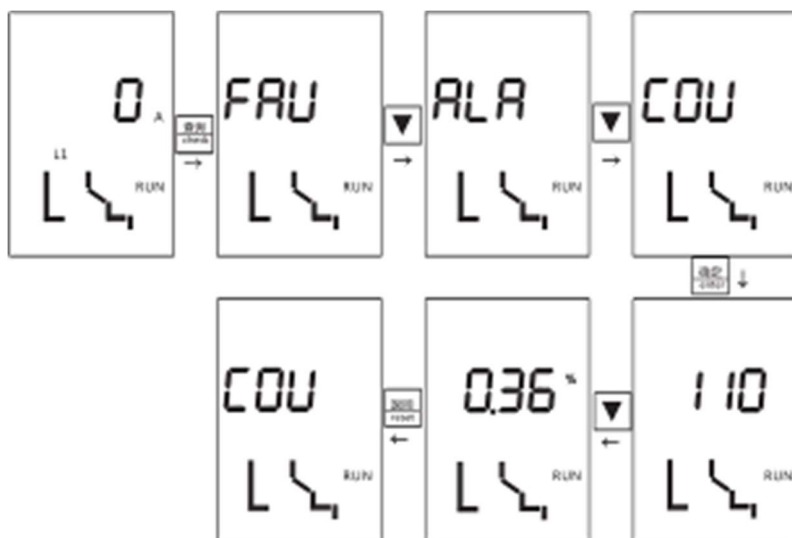
Рисунок 73. Просмотр записи о количестве срабатываний и сроке службы автоматического выключателя
