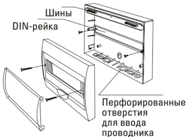
Рис. 1 - Схема монтажа ЩРН-П
