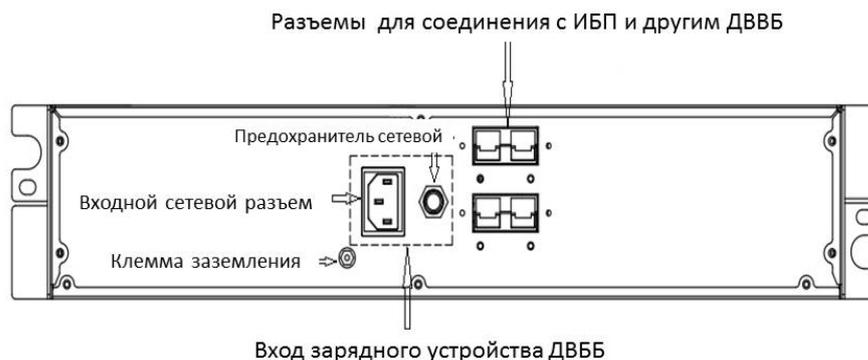
Рис. 8 Задняя панель ДВББ.
