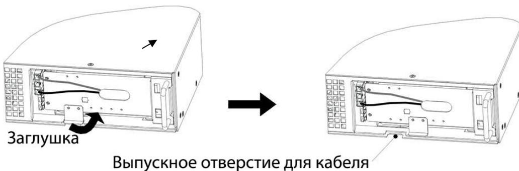
Рис. 2а Снятие кабельной заглушки ИБП.
