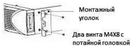
Рис.3 Установка монтажных уголков
