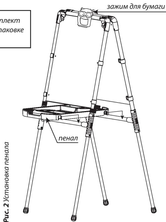
Рис. 2 Установка пенала
