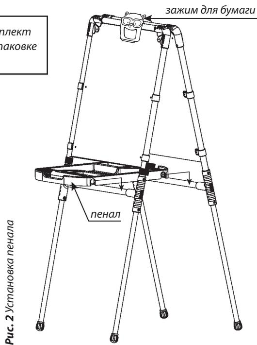
Рис. 2 Установка пенала
