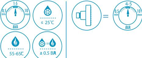
Termostaattihanoja ei suositella käytettäväksi yhdessä kaasu- ja sähkökäyttöisten läpivirtauslämmittimien kanssa.
