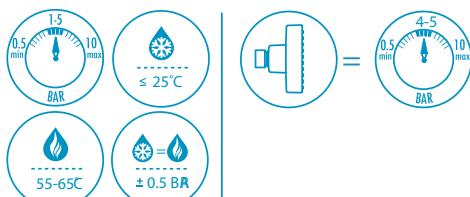
Не рекомендуется использовать термостатический смеситель совместно с проточными газовыми и электрическими водонагревателями.
