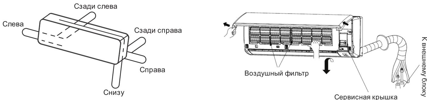
4. Пропустите провода межблочных соединений от наружного блока через отверстие в задней части корпуса внутреннего блока. Выведите их с лицевой стороны, предварительно открутив сервисную крышку.
