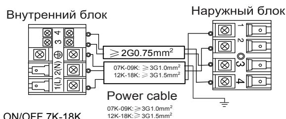
Для инверторных моделей используется кабель управления  $4 \times 1,5 \text{ мм}^2$ :
