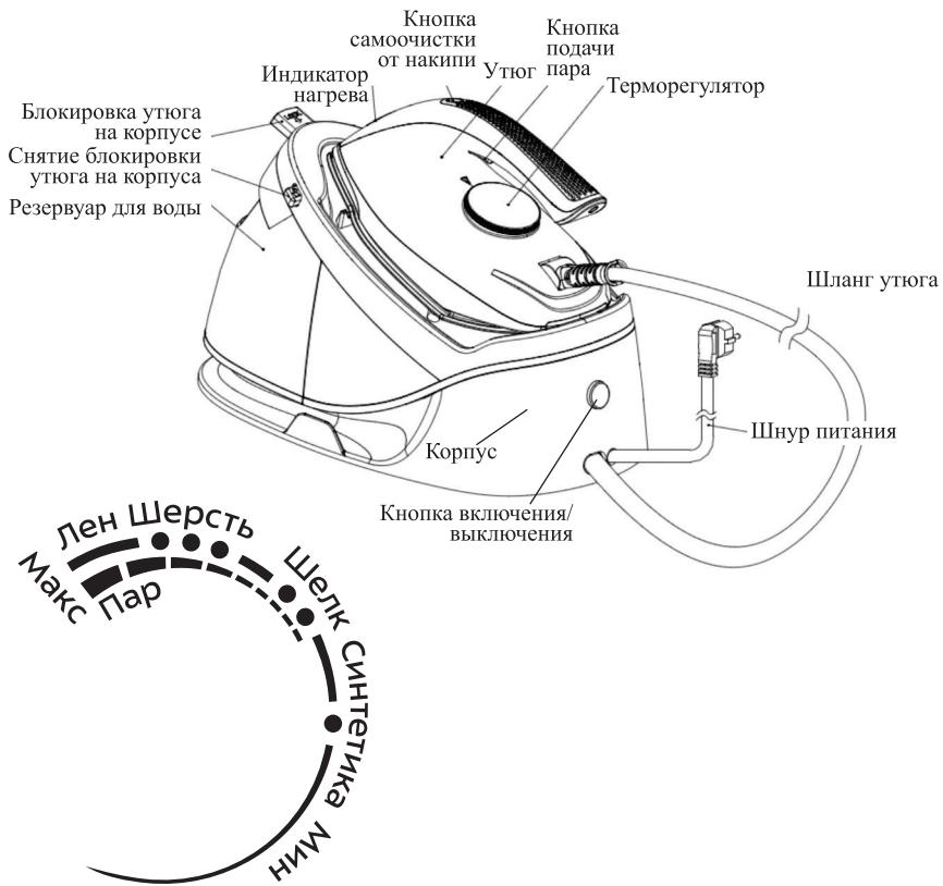
Принцип работы паровой станции прост: вода из резервуара с помощью помпы (водяного насоса) подается по шлангу в испаритель утюга, где под воздействием высокой температуры она превращается в пар и под давлением выходит из паровых сопел.
