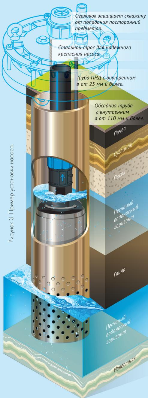
в насос большого количества песка. **При подаче насосом сильно загрязненной воды категорически запрещается выключать насос во избежание его заклинивания вследствие оседания песка из напорной магистрали.** Дайте ему поработать. Выключать насос следует только после того, как произойдет «прокачка» скважины и из трубопровода пойдет чистая вода.
