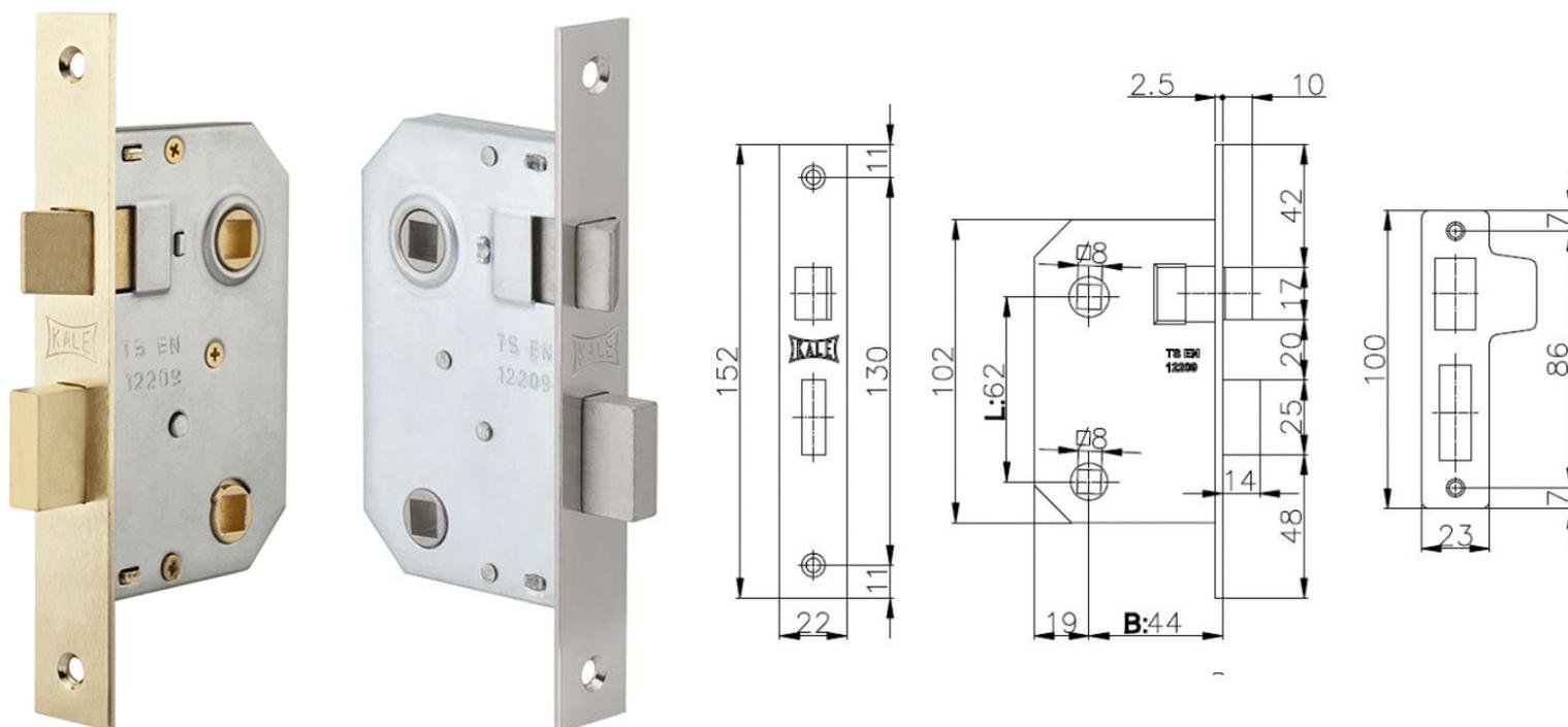
Защелка врезная **Kale 251 WC** предназначена для установки на межкомнатные деревянные двери. Оборудована механизмом дополнительного закрывания, так называемым WC-запираем.
