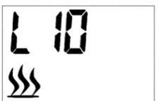
Нажмите кнопку + или -, чтобы отрегулировать температуру. Если установленная температура выше, чем температура в помещении, определенная прибором, начинается нагрев. Нагрев не начнется, если заданная температура ниже комнатной температуры.
