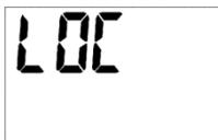
Нажмите и удерживайте кнопку включения / выключения более 6 секунд, чтобы заблокировать или разблокировать кнопки, на дисплее отобразится LOC, и будет показано, что кнопки заблокированы. Как только заблокированный LOC будет мигать в течение 6 секунд, а затем исчезнет, нажмите любую кнопку, и LOC снова начнет мигать. Нажмите и удерживайте кнопку ВКЛ / ВЫКЛ в течение 6 секунд, чтобы разблокировать кнопки. Обратите внимание, кнопка ВКЛ / ВЫКЛ никогда не блокируется.
