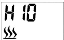
Нажмите кнопку + или -, чтобы отрегулировать температуру. Если установленная температура выше, чем температура в помещении, определенная прибором, начинается нагрев. Нагрев не начнется, если заданная температура ниже комнатной температуры.
