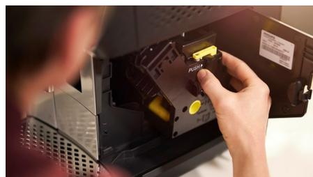
Варочная группа — это основной элемент любой автоматической кофемашины, который необходимо регулярно очищать. Съемную варочную группу можно тщательно очистить, просто сполоснув под струей воды.
