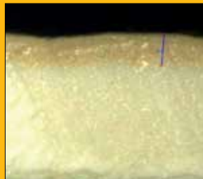
Сайдинг Дёке под микроскопом 200x
