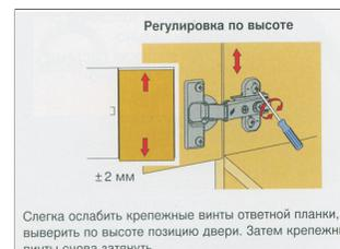
Слегка ослабить крепежные винты ответной планки, выверить по высоте позицию двери. Затем крепежные винты снова затянуть.
