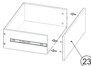
!Для более жесткой конструкции большого ящика дополнительно установить шканты 107!
