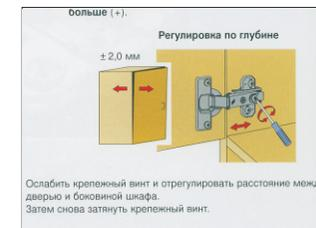
Ослабить крепежный винт и отрегулировать расстояние между дверью и боковой шкафа. Затем снова затянуть крепежный винт.
