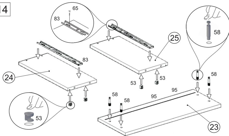
В изделии имеется четыре ящика поэтому данный этап сборки производится четыре раза.
