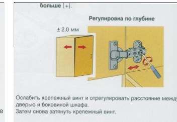
Инструкция по сборке представляет собой логическую последовательность действий с помощью которой без труда можно собрать мебельное изделие в домашних условиях.
