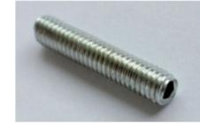
Ходовой ролик задней двери снабжен фиксатором в виде резьбового штифта М4, вкручивается в резьбовое отверстие при помощи специального шестигранного ключа (входит в комплект) после установки двери на направляющие верхнего ходового профиля. Данный штифт исключает самопроизвольный сход роликов с направляющих верхнего ходового профиля и падение двери.
