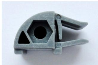
Крепится к вертикальной полке верхнего ходового профиля, как показано слева и справа. Крепится фиксатор болтом М5х30 и гайкой М5. Служит для ограничения хода двери в крайнем положении и от самопроизвольного отката (например, при неровности пола).
