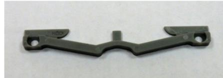
Крепится к передней вертикальной полке верхнего ходового профиля двумя шурупами 4x16 и служит для позиционирования средней двери трёхдверного шкафа в среднем положении. Стопор снабжен специальным язычком, с помощью которого можно изменить (уменьшить) усилие удержания передней двери в среднем положении. Достигается это подрезанием (укорачиванием) длины язычка.
