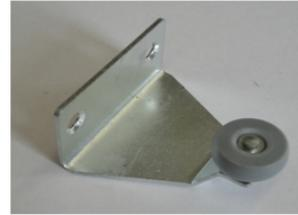
Крепится шурупами 4x16 к нижней кромке двери с внутренней стороны по 2 штуки на дверь. Служит направляющим элементом нижней части двери.
