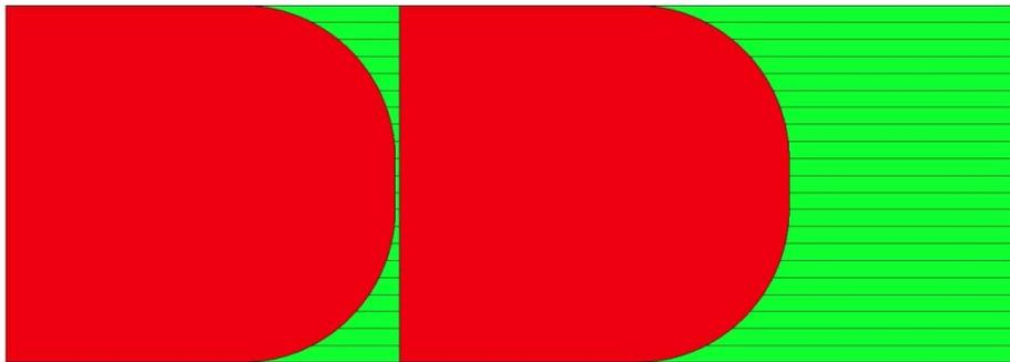
**Рисунок 2.1 – Схема раскроя листов сотового поликарбоната размерами 6х2,1 м для покрытия торцов каркаса теплицы**
