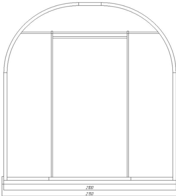
**Рисунок 4.2 – Размеры для закладки фундамента**
