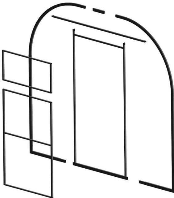
Рисунок 1.2 – Схема сборки торцов каркаса теплицы (изнутри теплицы)
