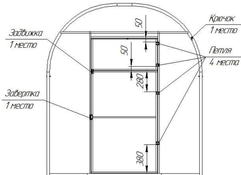
Рисунок 2.3 – Расположение заверток, петель и крючков на торце каркаса
