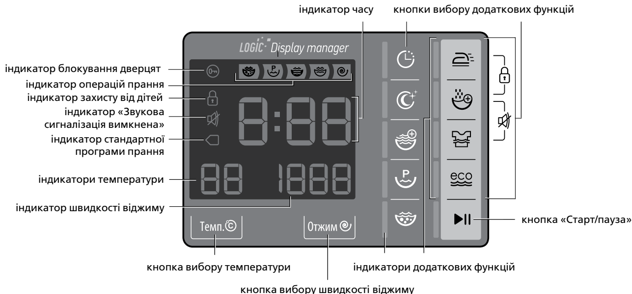
Малюнок 3 – Зони індикації і кнопки управління
