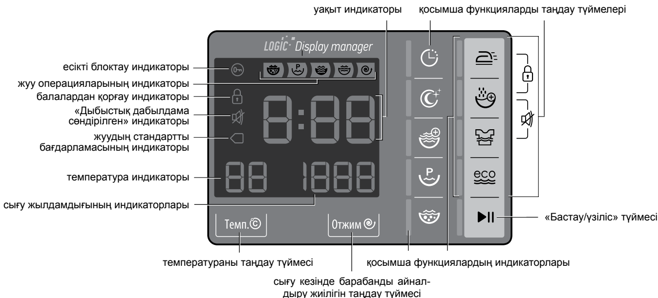
3-сурет – Индикация аймақтары және басқару түймелері
