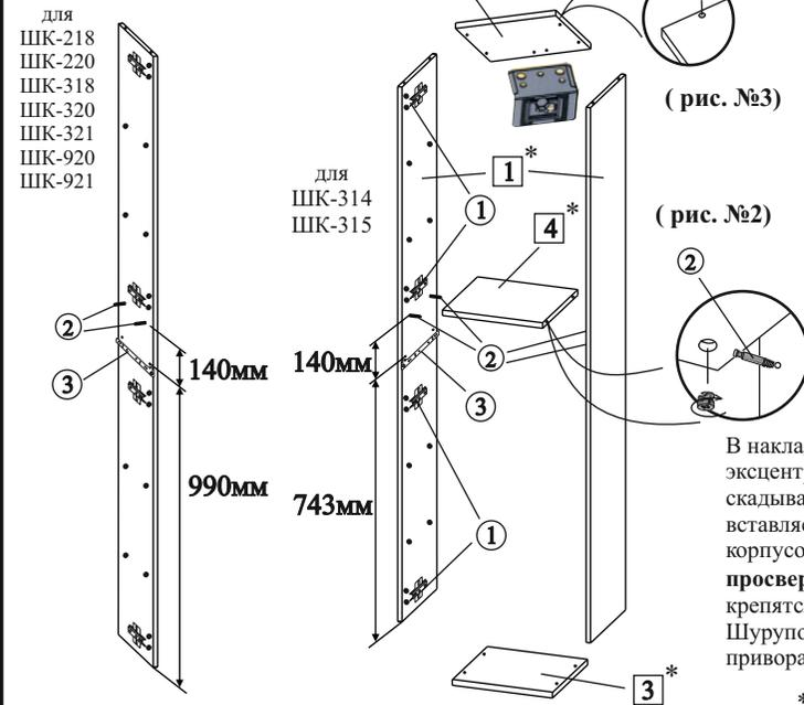
В накладку ящика вворачивается дюбель эксцентриковой стяжки. Ящик складывается согласно схеме, в паз вставляется дно, накладка стягивается с корпусом ящика. **Предварительно просверлив отверстия Ø 2,5 мм,** крепятся направляющие шурупами 4x13. Шурупом 4x16 через фиксатор приворачиваем дно ящика (рис. №7)
