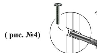
После установки всех секций наместо и их выравнивания сверлятся отверстия Ø8мм. и корпуса стягиваются между собой межсекционной стяжкой.
