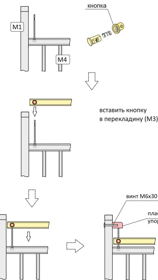
Порядок сборки соединений на эксцентриковые стяжки
