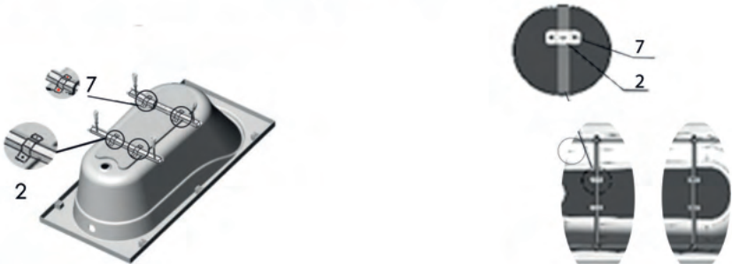
Рисунок 5 – фиксация ножек ванны
