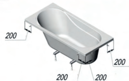
Рисунок 6 – крепление ванны к стене
